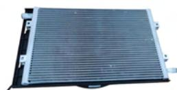
CONDENSADOR DE AR CONDICIONADO VOLVO
