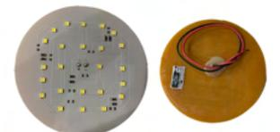
PLACA DE LED LANTERNA BOJUDA 24 LEDS 24V
